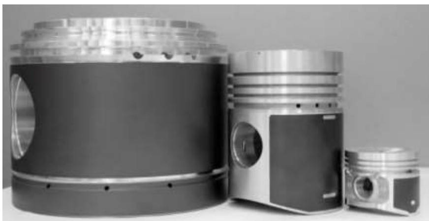
Рис. 4. Поршни с твердосмазочными покрытиями MODENGY
